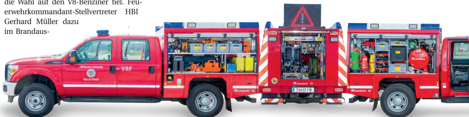
konnte eine Teleskopleiter platzsparend verstaut werden. Ergänzend zur Mindestbeladung wurden im Geräteraum 2 drei Stück Pressluftatmer Auer BD 96 Mini samt Reserveflaschen untergebracht. Im tiefgezogenen Außenstaufach befinden sich Absperrmaterial sowie sechs Stück faltbare Verkehrsleitkegel oder auch ein Absperrband zur Absicherung der Einsatzstellen.
