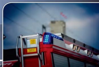
Um den Bereich rund um das Fahrzeug angemessen auszuleuchten, wurde in den Dachblenden eine LED-Umfeldbeleuchtung integriert. LED ist die Kurzform für Licht emittierende Diode.
