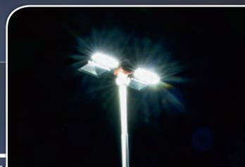
Für die Ausleuchtung der Einsatzstelle wurde ein pneumatisch ausfahrbarer, dreh- und schwenkbarer LED-Lichtmast mit acht Strahlern installiert, der vom Pumpenbedienstand aus in Betrieb genommen werden kann.
