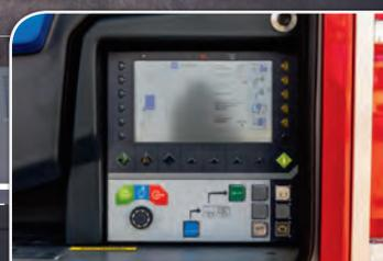
Mit dem Rosenbauer LCS – Logic Control System lassen sich verschiedenste Pumpenfunktionen steuern. Zur einwandfreien Bedienung bei schlechten Lichtverhältnissen und in der Nacht sind alle Funktionen hinterleuchtet ausgeführt.
