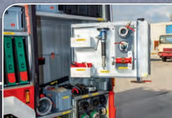
Zusätzlich zur üblichen Branddienstausrüstung, sind auch zwei C-Sonderanfertigungen für Druckluftzuführung (z.B.: Ölsperren) und ein Wasserhahn als Ergänzung zum Hygieneset mit an Bord.
