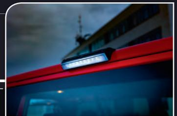
Die Umfeldbeleuchtung in LED-Ausführung sorgt für ausreichend Helligkeit in der näheren Umgebung des Fahrzeuges. Betrieben wird die Umfeldbeleuchtung mit der Bordspannung des Fahrzeuges.
