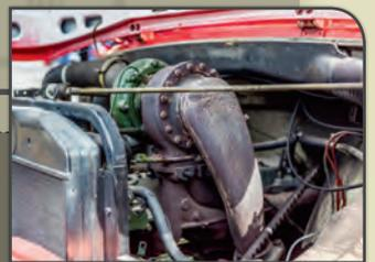
Der Sechszylinder Dieselmotor, des Typs OM 352A, markierte damals den Stand der Technik. Der ursprünglich als „Sauger“ konzipierte Motor wird von einem Turbolader mächtig unter Druck gesetzt: 150 PS Leistung sind das Resultat.
