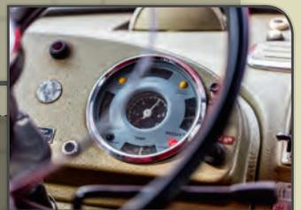
Klassische Rundinstrumente mit integrierten Anzeigen geben Auskunft über Temperatur, Öldruck, Spannung, ...
