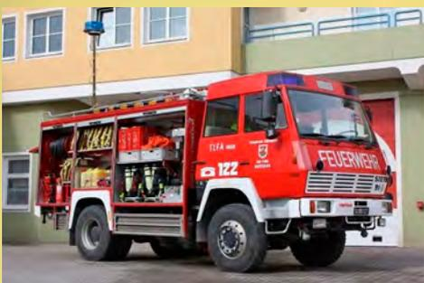
Bj. 1986, Steyr 1291 4x4, 280 PS, Aufbau Rosenbauer, Besatzung 1:5, 4.000l Tank, NH Pumpe 2400l/250l, 2 HD Schnellangriff, fix eingebauter Zumischer in B Abgang, Lichtmast, Wasserwerfer, Straßenwaschanlage, Notstromerzeuger 8 kVA, Teile der Beladung je nach Bedarf, neue Reifen.
