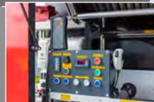
Die Normaldruckpumpenlösung wird elektronisch gesteuert. Eine Schlauchhaspel mit formstabilem C-Druckschlauch befindet sich im Heck. Der Wassertank fasst 300 Liter.
