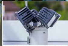
Wie die beiden „großen Brüder“ HLF 2 und 3 verfügt auch dieses HLF 1 über einen pneumatisch ausfahrbaren, drehbaren LED-Lichtmast, der über die Fahrzeugspannung betrieben wird.
