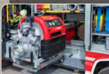
Auf einem Drehfach im Geräteraum 1 ist die Tragkraftspritze unter-
