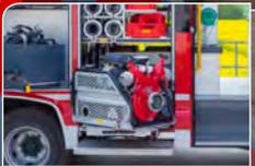
Mit 145 kg und den Außenabmessungen von 910 mm x 597 mm x 755 mm passt die 750 Liter/10 bar fördernde Feuerlöschpumpe exakt auf ein Drehfach im Geräteraum 2.
