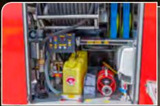
Im heckseitigen Pumpenbereich ist zusätzlich zur Lichtmaststeuerung auch das Hygieneset sowie die vollständige Ausrüstung für einen Schaumangriff untergebracht.
