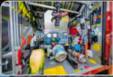
Der 50 Meter lange, formstabile C-Druckschlauch wird mit einer manuell zu bedienenden Normaldruckpumpenlösung (Rosenbauer FPN 10 - 1000) gespeist.
