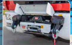
Unter der Kennzeichenhalterung versteckt sich die 36 kN-Elektroselwinde, die mit einem Kunststoffseil ausgestattet und somit ideal vor Umwelteinflüssen geschützt ist.
