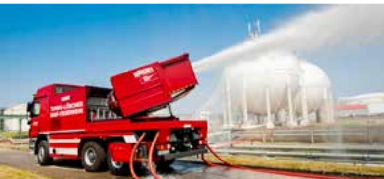
▶ **Turbolöcher:** Dieses Sonderlöschgerät erreicht eine Wurfweite von 150 bis 170 Metern. Bis zu 8 Tonnen Wasser pro Minute gehen durch die Düsen. Der große Vorteil liegt im Nebeneffekt aufgrund der feinen Zerstäubung. Die BTF BASF hat aktuell zwei Turbolöcher im Einsatz. Die Turbinen sind entkoppelbar und können dadurch auch per Hubschrauber oder Bahn verbracht werden.
