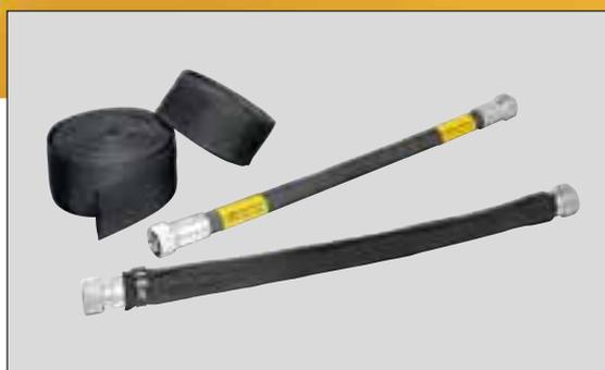
Der Berstschutzschlauch HEGWS ist ein extrem reißfester und robuster Hydraulikschutzschlauch. Dieser wird zum Beispiel zum Schutz von Hydraulikleitungen sowie zur Unfallverhütung vor Ölstrahlverletzungen eingesetzt. HEGWS wird oft in Erdbaumaschinen-Schutzeinrichtungen oder bei starken mechanischen Vibrationen verwendet.
