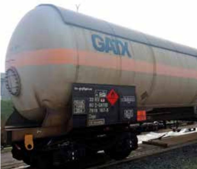
Abbildung 7: Kesselwaggon Propen (Propylen) ▶
