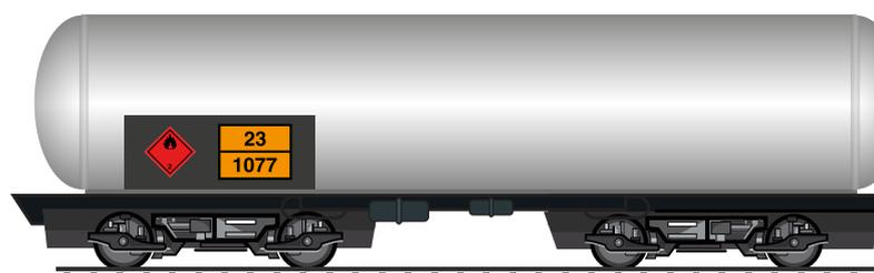
Abbildung 6: Kennzeichnung „Eisenbahnwagen“
