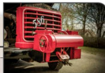
Die Martin-Seilwinde hat noch immer massig Zugkraft und wird nicht hydraulisch, sondern mechanisch betrieben. Mit 45 Kilonewton zieht das Gerät seinen modernen Nachfahren um nichts nach.
