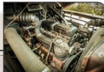
Der 120 PS starke Sechszylinder-Vorkammer-Diesel der Motorbaureihe WD-609 verfügt über einen Hubraum von 5976 ccm und stellt ein Drehmoment von 360 Newtonmeter bei 1.600 Umdrehungen pro Minute bereit.
