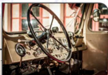
Das große Lenkrad ist fast zu klein geraten, insbesondere, weil die fehlende Servounterstützung kräftige Oberarme verlangt und jeder Manöviervorgang viel Zugkraft benötigt. Anzeigen und Schalter versprühen Chrom und Klassik.
