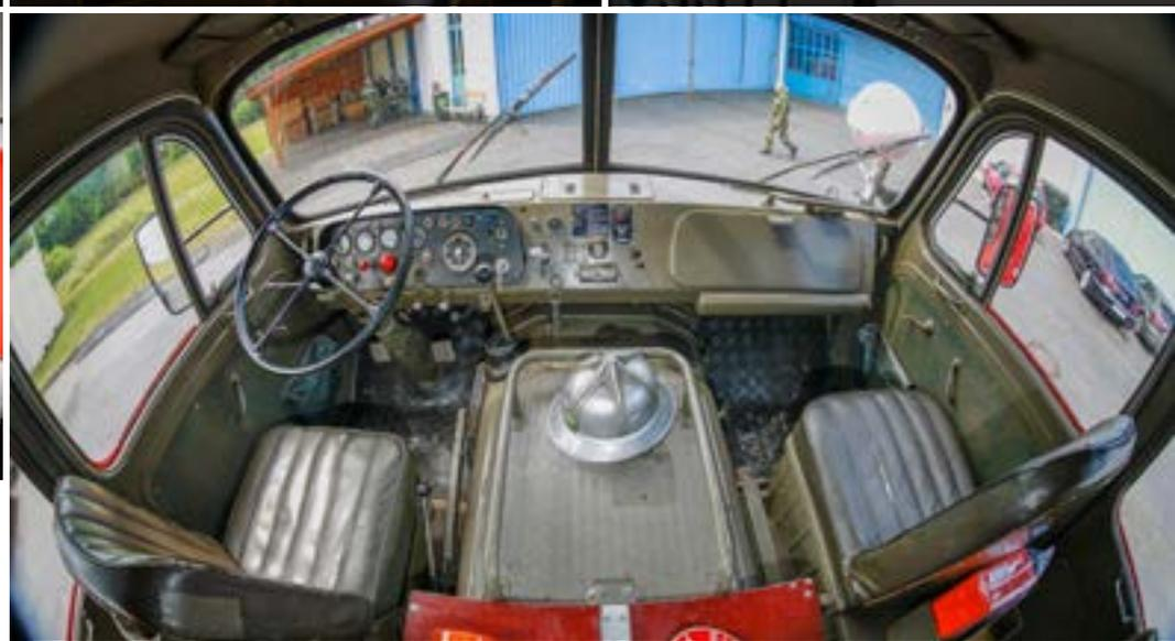
Durch den Wegfall der „Schnauze“ rutschte der Motor unter die Fahrerkabine. Dennoch bietet die
