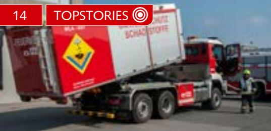
Der Wechselladeaufbau wird abgesattelt.
