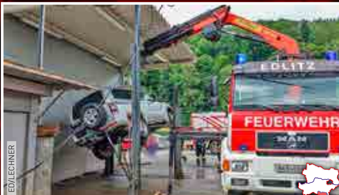
Thomasberg: Eine geplatzter Hydraulikschlauch ließ eine Hebebühne unkontrolliert absinken. Der darauf befindliche Geländewagen rutschte ab und verkeilte sich. Mit Hilfe des Krans und eines Staplers konnte der Wagen geborgen werden.
