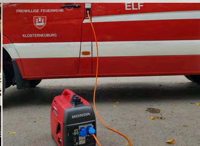
Autarke Stromversorgung mit einem 2 kVA-Stromerzeuger.
