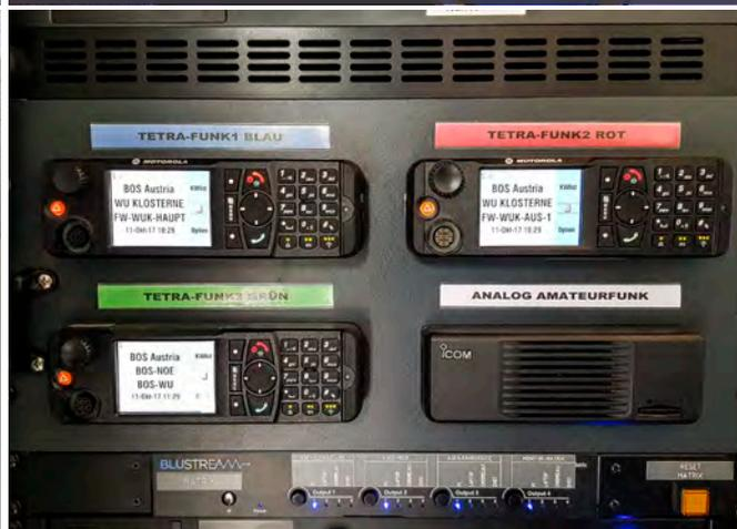
Die Fahrzeugfunkgeräte sind fix in einem Rack verbaut.
