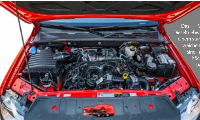
Das Vierzylinder-Dieselmotor musste einem starken V6-TDI weichen. Damit sind nun in der höchsten Ausbaustufe 224 PS und 550 Newtonmeter Drehmoment verfügbar.
