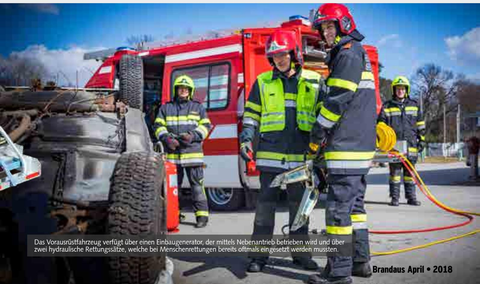
Das Vorausrüstfahrzeug verfügt über einen Einbaugenerator, der mittels Nebenantrieb betrieben wird und über zwei hydraulische Rettungssätze, welche bei Menschenrettungen bereits oftmals eingesetzt werden mussten.
