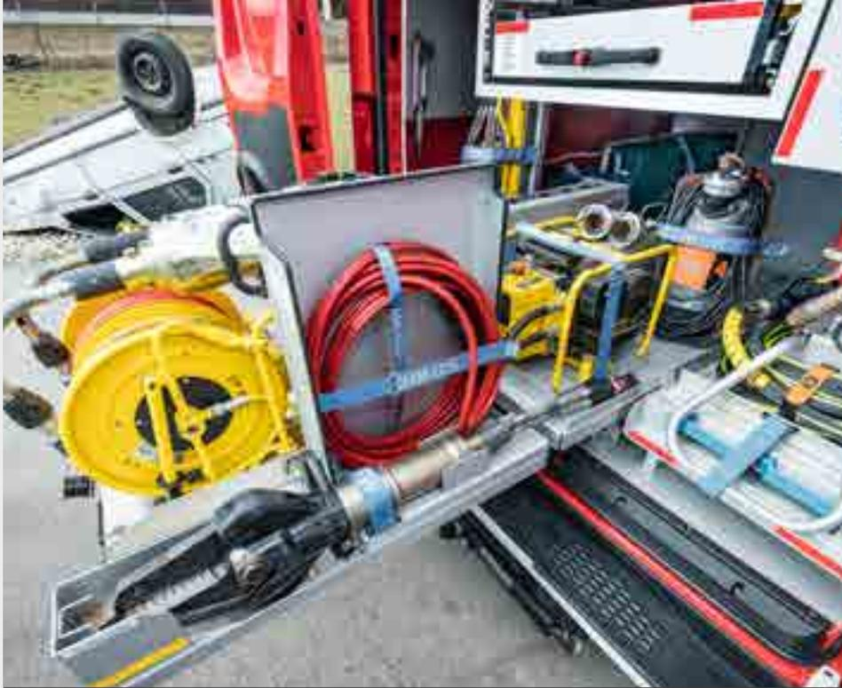
Die beiden Rettungsgeräte wurden auf dem Geräteauschub platzsparend untergebracht. Die Entnahme gestaltet sich einfach und rasch, sodass keine Zeit bei der Menschenrettung verloren geht.
