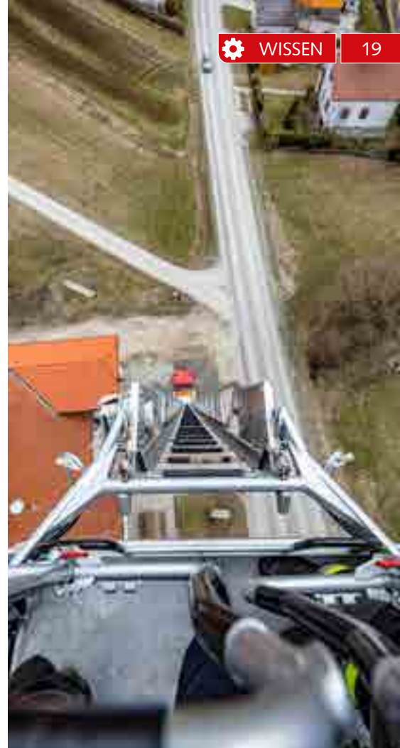
Die DLK 23-12 verfügt über eine Nennrettungshöhe von 23 Metern bei einer Nennausladung von 12 Metern.
