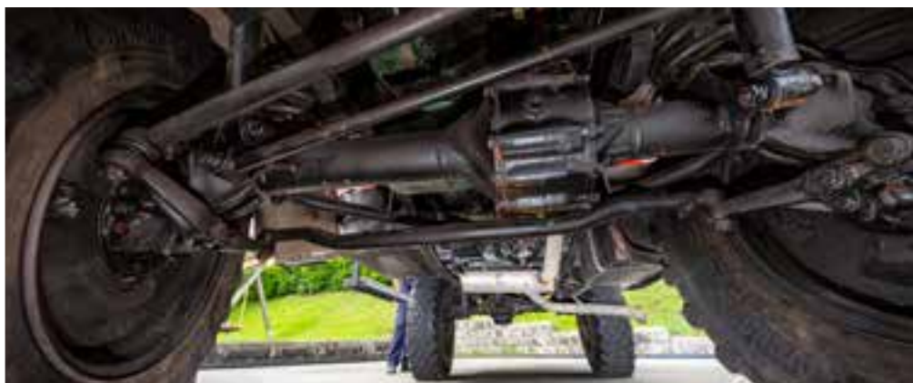
Die robusten Portalachsen sind mittels Doppelfedersystem (Vorgänger der Progressivfedern) aufgehängt. Somit ist ein komfortables Fahren auf der Straße als auch im Gelände gegeben.
