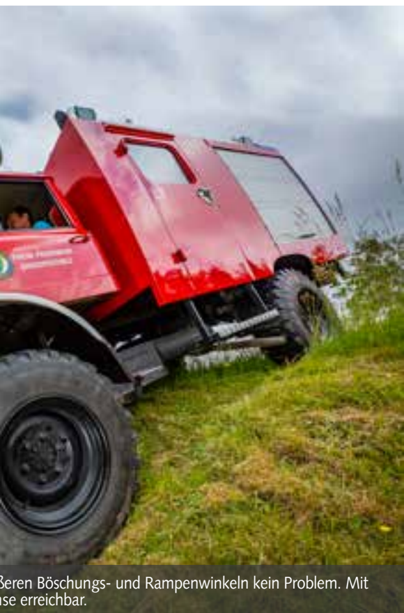
Die robusten Portalachsen sind mittels Doppelfedersystem (Vorgänger der Progressivfedern) aufgehängt. Somit ist ein komfortables Fahren auf der Straße als auch im Gelände gegeben.
