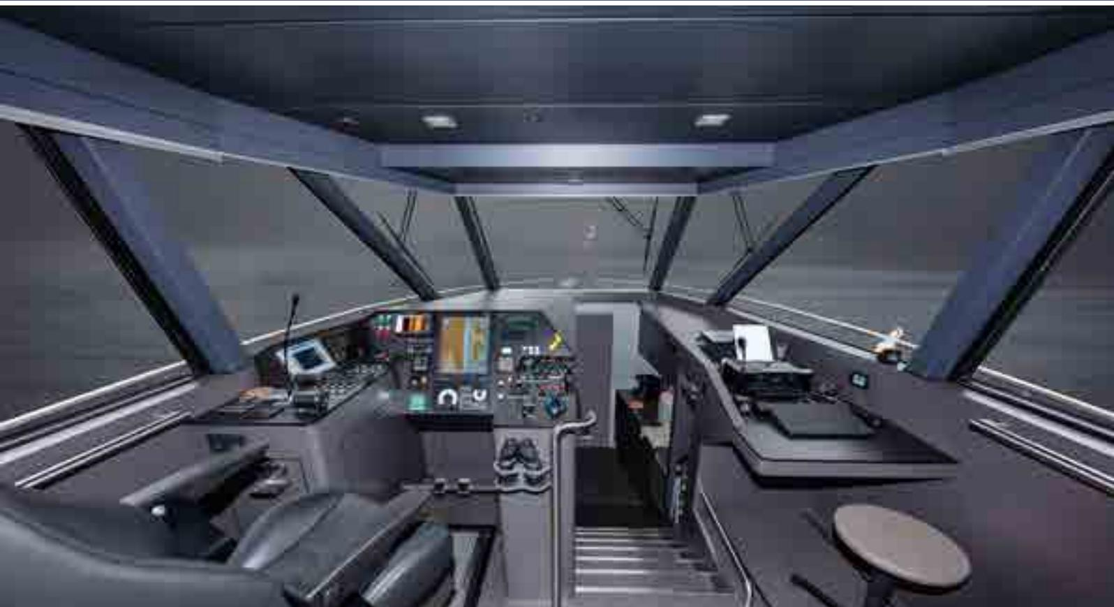
Das futuristisch anmutende Cockpit der „Wien“, ausgestattet mit Navigation, Radar und Echolot. Um künftig auch mit den Einsatzkräften via Funk zu kommunizieren, werden BOS-Funkgeräte nachgerüstet. Die derzeitige Funkausrüstung ist rein auf die Schifffahrt ausgelegt.
