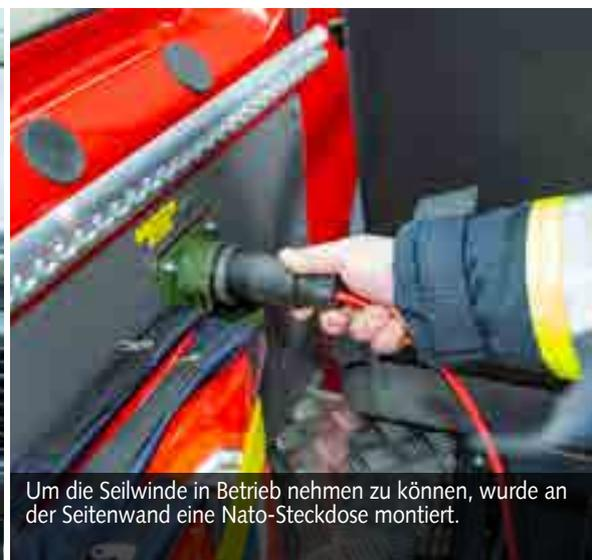
Um die Seilwinde in Betrieb nehmen zu können, wurde an der Seitenwand eine Nato-Steckdose montiert.
