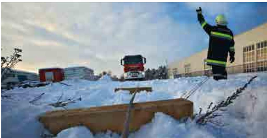
Das Seil der Seilwinde ist oftmals harten Bedingungen ausgesetzt. Um eine unnötig hohe Abnutzung durch Verschmutzung aber auch Abrieb zu vermeiden, sollten Kantenschoner wie beispielsweise Kantschutzhölzer als Schutz und Gelithilfe eingesetzt werden. Nur eine Person gibt Kommandos an den Einsatzmaschinenisten, der die Seilwinde bedient. Die restliche Mannschaft gibt sich aus dem Gefahrenbereich.
