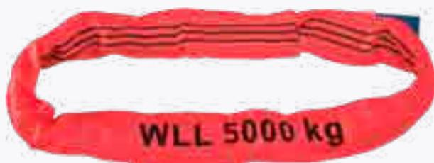
Eine Rundschlinge (auch Schlupf genannt) ist ein Anschlagmittel, das bis zu 400 Tonnen tragen kann. Hergestellt wird sie aus hochfestem, licht- und wärmostabilisiertem PES-Multifilament, das endlos gewickelt wird. Die fertige Rundschlinge ist dadurch sehr flexibel, sodass sie sich mühelos an die Konturen jeder Last anpasst. Rundschlingen sind je nach Traglast farblich unterschiedlich gekennzeichnet, siehe dazu die Tabelle „Rundschlingendimensionierung“ auf der nächsten Seite.
