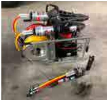
Hydraulikaggregat mit Schere LS200B, Spreizer LSP44C und Hydraulikstempel mit Verlängerung
