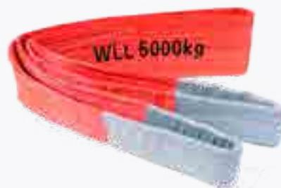
Ein Hebeband ist ein textiles Anschlagmittel mit einer Nenntragfähigkeit von bis zu 20 Tonnen. Sie bestehen aus in Längsrichtung übereinander gelegten flachgewebten Gurtbändern. An beiden Seiten des Hebebändes befinden sich je nach Ausführung Schlaufen oder metallene Beschlagteile. Die Hebebänder können weiterhin mit Secutex-Schutzschläuchen oder mit einer Secutex-Festbeschichtung aus Polyurethan versehen werden. Das „Gelege“ ist aus hochfestem, licht- und wärmostabilisiertem PES-Multifilament.
