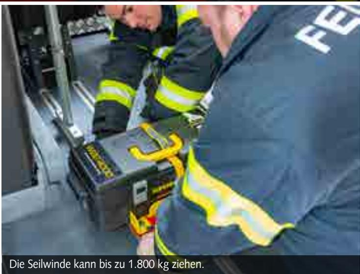
Die Seilwinde kann bis zu 1.800 kg ziehen.
