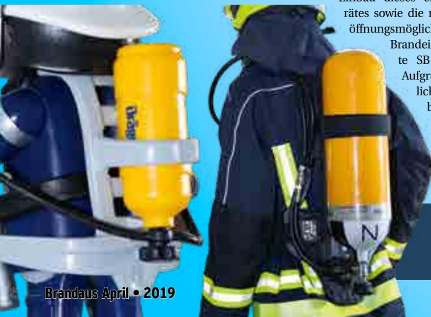
**Bilder links:** Ein Atemschutzgerät mit 300 bar, 6 Liter-Atemluftflasche. 1.800 Liter Atemluft stehen so dem Atemschutzgeräteträger zur Verfügung, um umluftunabhängig zum Beispiel Menschenrettungen oder Löschangriffe im dicht verrauchten Gebäudeinneren durchführen zu können.
