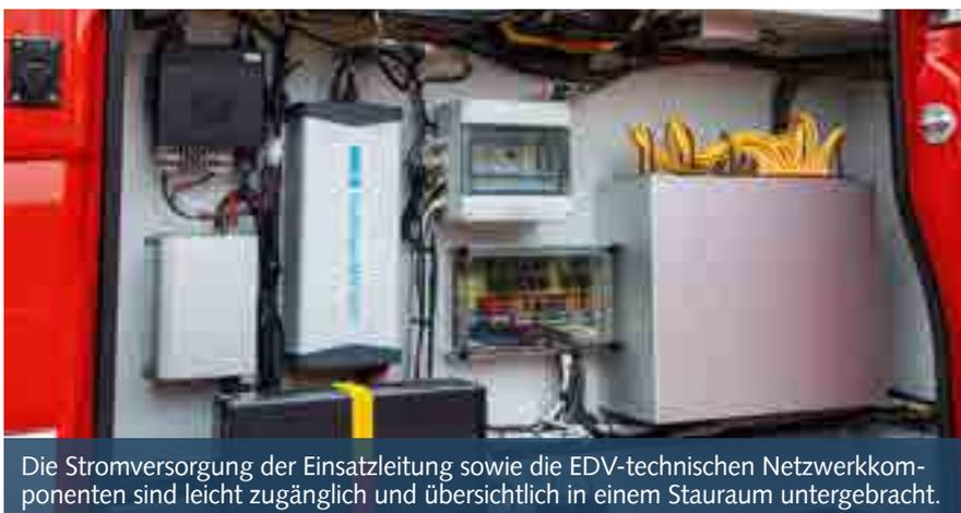
Die Stromversorgung der Einsatzleitung sowie die EDV-technischen Netzwerkkomponenten sind leicht zugänglich und übersichtlich in einem Stauraum untergebracht.
