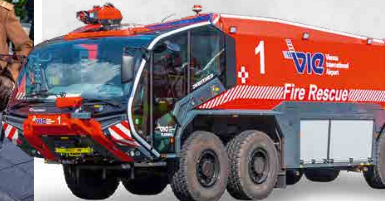
Gleich gegenüber war der Panther 8x8 aufgestellt. Das modernste Flughafenlöschfahrzeug, ausgestattet mit zwei 750 PS-starken Diesellaggregaten wurde von der Betriebsfeuerwehr Flughafen Wien/Schwechat, unter der Führung von Roland Pachtner beigestellt. Der Wassertank beinhaltet 14.000 Liter Löschwasser; die Pumpenleistung beleuft sich auf 10.000 Liter pro Minute.
