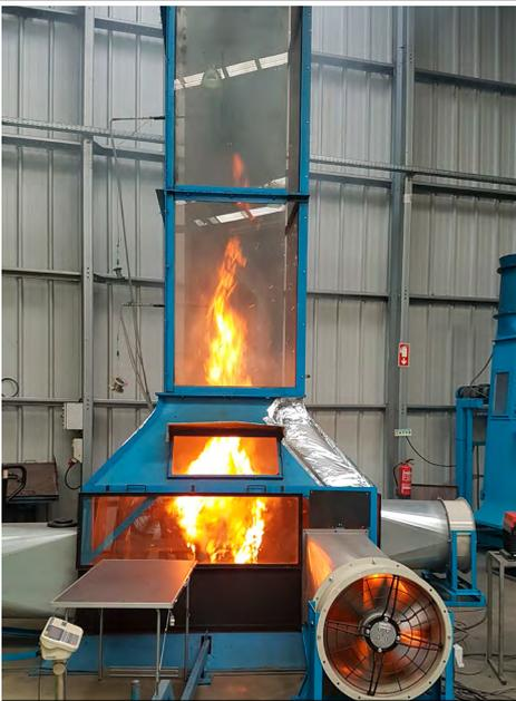
Feuerwirbelgenerator (vertikaler Verbrennungstunnel) mit dem enorme hitzebedingte Aufwinde simuliert werden können.
