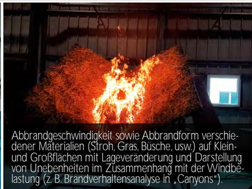
Abbrandgeschwindigkeit sowie Abbrandform verschiedener Materialien (Stroh, Gras, Büsche, usw.) auf Klein- und Großflächen mit Lageveränderung und Darstellung von Unebenheiten im Zusammenhang mit der Windbelastung (z. B. Brandverhaltensanalyse in „Canyons“).
