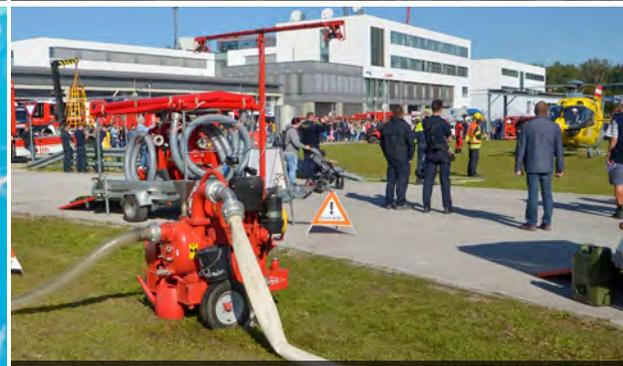
Die Großpumpensysteme SPA200 und SPA900 waren beim Übungsteich ausgestellt. Bis zu 900 Kubikmeter Wasser pro Stunde fördert eine SPA900. Im Vordergrund ist eine SPA200 zu sehen.
