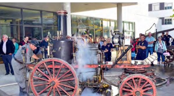
Die Dampfspritze „Kati“ der FF Gainfarn, Baujahr 1910, stellte ihre Leistungsfähigkeit ebenso unter Beweis, wie der NAG Typ B der BTF Traisen, Baujahr 1905. 1914 wurde dieses Fahrzeug zu einer Motorspritze mit 750 Liter pro Minute Förderleistung umgebaut.
