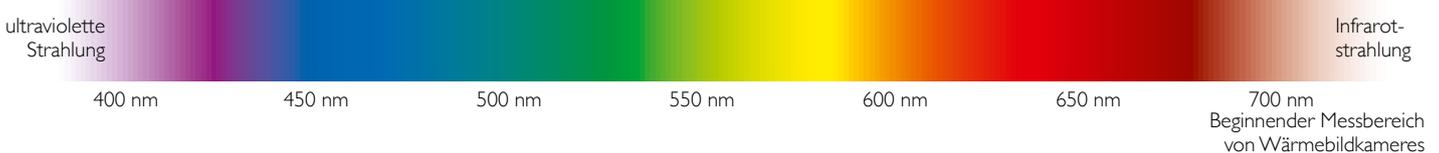
Das Spektrum eines thermischen Strahlers ist kontinuierlich, das heißt, es treten alle Wellenlängen auf, wobei die spektralen Anteile nach dem Planckschen Strahlungsgesetz ausschließlich von der Temperatur abhängen, jedoch, abgesehen vom spektralen Emissionsgrad, nicht vom Material des Strahlers.
