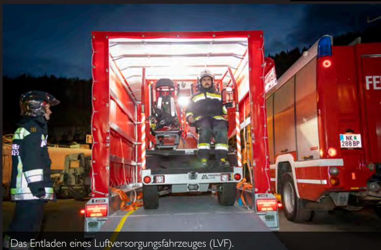
Das Entladen eines Luftversorgungsfahrzeuges (LVF).
