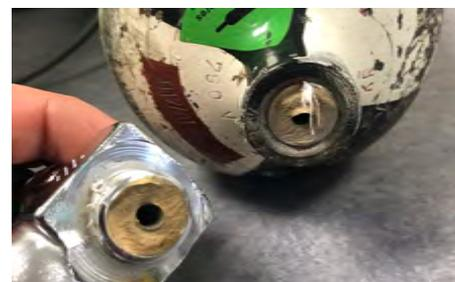
Ein gebrochenes Ventil. Mit Abströmsicherung stellt die Atemluftflasche keine Gefahr dar. Ohne Abströmsicherung wird die Flasche zu einem gefährlichen Geschöß.
