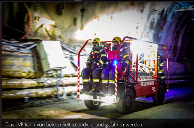
Das LVF kann von beiden Seiten bedient und gefahren werden.
