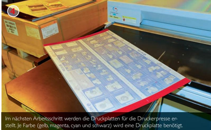
Im nächsten Arbeitsschritt werden die Druckplatten für die Druckerpresse erstellt. Je Farbe (gelb, magenta, cyan und schwarz) wird eine Druckplatte benötigt.
