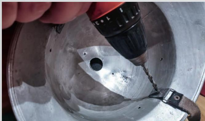
Die Nieten der Kinnriemenhalterung mit einem 6 mm HSS-Bohrer behutsam aufbohren.
