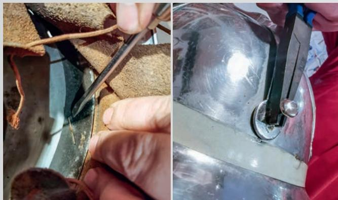
Beim Geradebiegen der Splinte ist besondere Vorsicht geboten, da diese sehr leicht Brechen und nur mehr schwer erhältlich sind.
