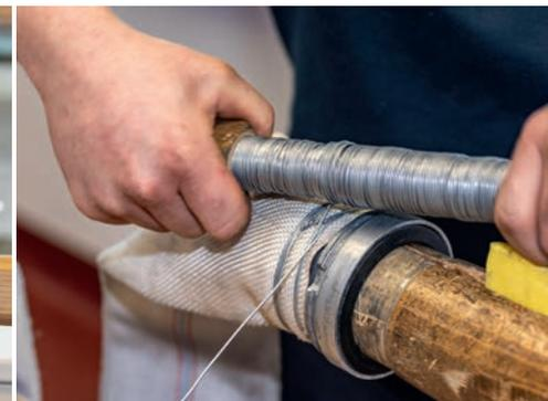
Feuerweherschläuche werden im Einsatz und bei Übungen sehr hart beansprucht. Im Inneren der Wasserdruck und Außen kann der Kunstfasermantel des Schlauches an Kanten beschädigt werden. Für die Reparaturarbeiten, sowie das neu Einbinden von Schläuchen ist der Zeugmeister zuständig.
