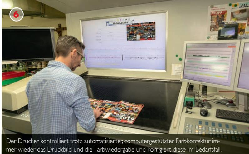
Der Drucker kontrolliert trotz automatisierter, computergestützter Farbkorrektur immer wieder das Druckbild und die Farbwiedergabe und korrigiert diese im Bedarfsfall.
