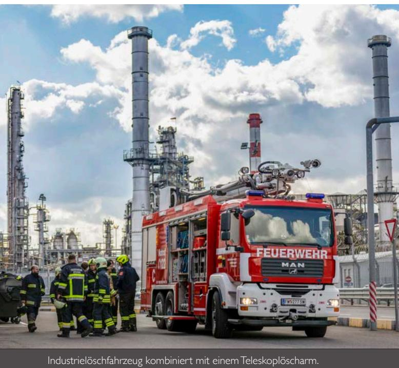
Industrielöschfahrzeug kombiniert mit einem Teleskoplöscharm.
