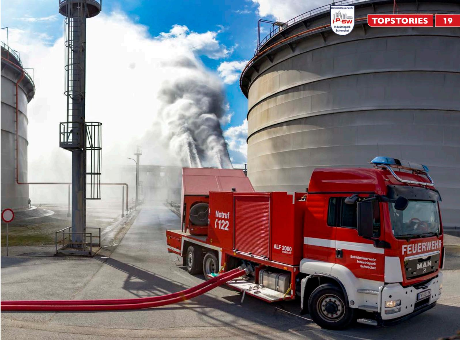
Dieses Fahrzeug, ein Aerosollöschfahrzeug, auch Turbolöschler genannt, ist mit zwei Flugzeugturbinen zu je 5.000 PS ausgestattet, welche das Löschwasser zerstäubt um einen Brand zu löschen oder giftige Dämpfe und Brandrauch niederzuschlagen, es dient somit auch als „mobiles Hydroschild“ mit einer maximalen Löschleistung von bis zu 8.000 Liter pro Minute.
