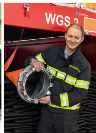
Der große, mobile Wasserwerfer hat eine maximale Förderleistung von bis zu 30.000 Liter pro Minute. Die zugehörigen Schläuche haben einen Durchmesser von 30 Zentimeter.
