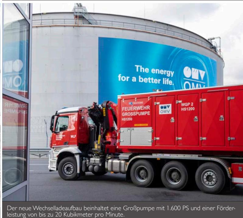
Der neue Wechselladeaufbau beinhaltet eine Großpumpe mit 1.600 PS und einer Förderleistung von bis zu 20 Kubikmeter pro Minute.
