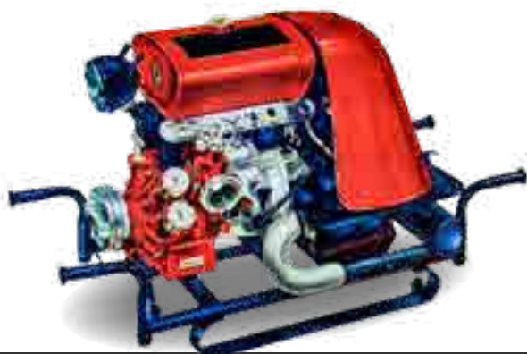
Ab 1953 wird der Industriemotor Typ 122, ein luftgekühlter 4-Zylinder-4-Takt-Boxermotor mit anfangs 30, später 34 PS, in die Tragkraftspritze RVW 75 eingebaut.
