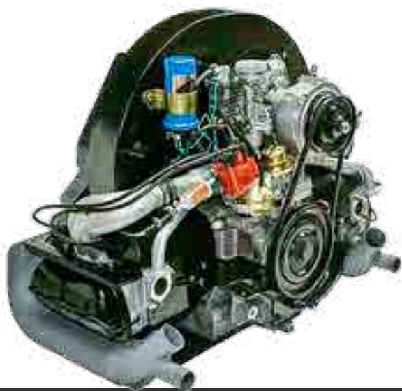
Ab 1953 wird der Industriemotor Typ 122, ein luftgekühlter 4-Zylinder-4-Takt-Boxermotor mit anfangs 30, später 34 PS, in die Tragkraftspritze RVW 75 eingebaut.
