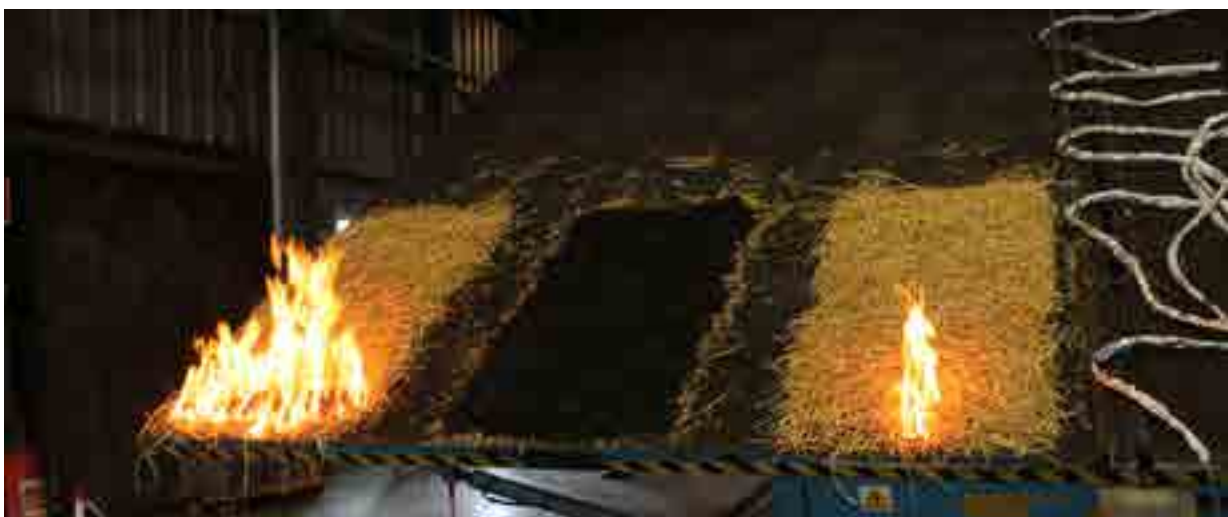
Brandverlaufsdarstellung bei Laborversuchen. Es können verschiedene Hangneigungen dargestellt werden. Beeindruckend sind die unterschiedlichen Brandverläufe, je nach Hang- bzw. Böschungsneigung.
