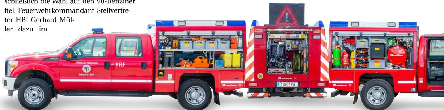
konnte eine Teleskopleiter platzsparend verstaut werden. Ergänzend zur Mindestbeladung wurden im Geräteraum 2 drei Stück Pressluftatmer Auer BD 96 Mini samt Reserveflaschen untergebracht. Im tiefgezogenen Außenstaufach befindet sich Absperrmaterial wie sechs Stück faltbare Verkehrsleitkegel oder auch ein Absperrband zur Absicherung der Einsatzstellen.
