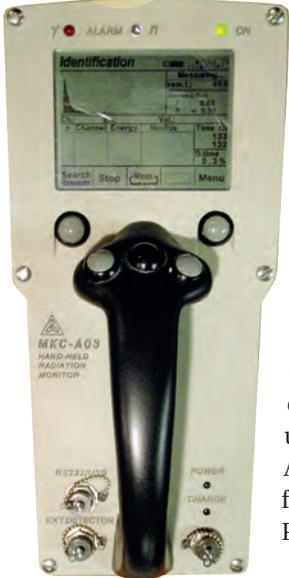
Ein Gammaskpektrometer MKC-A03 im Analysemodus
