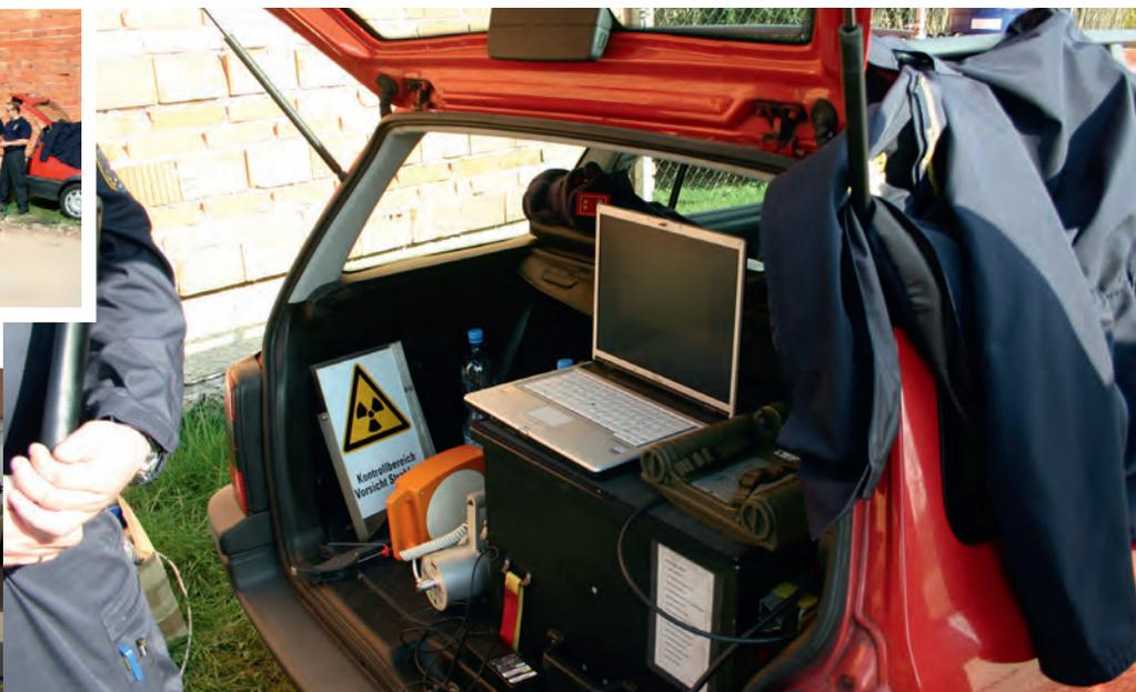
Auswerte-PC mit einem von Manfred Ertl entwickeltem Programm (Alarm, Speicherung)
