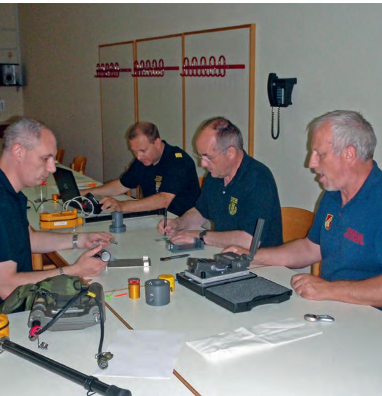
Alle Meßgeräte werden einmal im Jahr durch das Prüfteam kontrolliert
