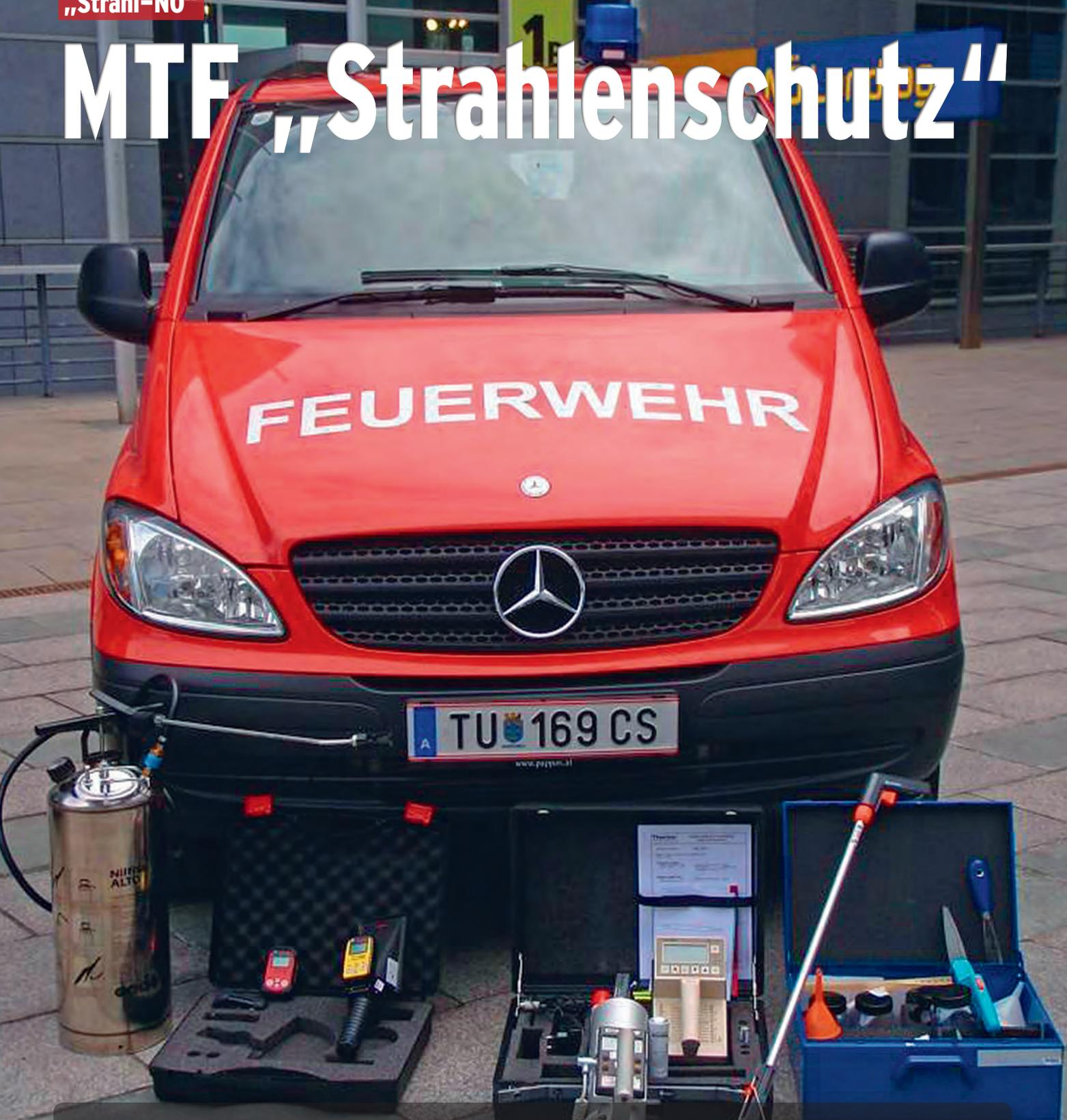
Dem Sonderdienst steht ein Kleintransporter Mercedes VITO zur Verfügung. Das Fahrzeug verfügt über ein automatisches Getriebe und Allradantrieb. Um das Fahrzeug optimal nutzen zu können, sind kleine Umbauten durchgeführt worden. So wurde ein Arbeitstisch mit eigener Beleuchtung hinter dem Fahrersitz sowie ein Spannungswandler (Bordspannung auf 230 V Netz-
