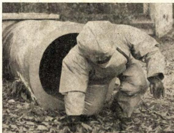
Erprobung der Bewegungsfreiheit im Strahlenschutzanzug.
