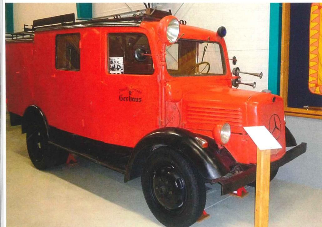
**Bild links: Dieses Löschfahrzeug 8 stand 1943 bis 1957 bei der FF Bruck an der Leitha** in Verwendung (vorübergehend sogar als Sanitätswagen). Es wurde anschließend an die Feuerwehr Gerhaus verkauft. Baujahr: 1942, Fahrgestell: Mercedes Benz L1500 S; Aufbau: vermutlich Magirus, Ulm (Archiv FF Bruck).
