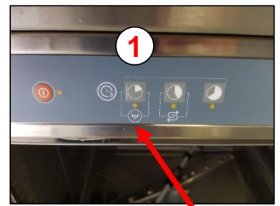
Bild 9 – Spültaste 1 (3 Sek.) = Taste für automatische Entleerung
