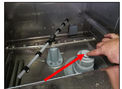
Bild 12 – Entleerungsrohr wieder einsetzen
