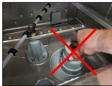
Bild 8 – Schmutzfilter NICHT entfernen!
