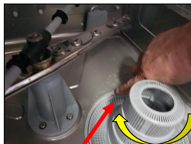
Bild 11 – Führungszapfen beachten und 1 cm im Uhrzeigersinn drehen
