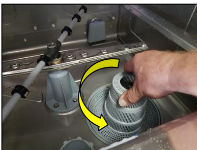
Bild 10 – Filtereinsatz 1 cm gegen den Uhrzeigersinn drehen und herausnehmen
