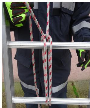
Die Leitersicherung wird über zwei Leitersprossen unter der Leiter stehend durchgeführt:
