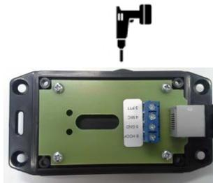
**2** Für Kabeldurchführung Gehäuse an
