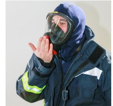
Dicht- und Ausatemventilprüfung der Vollmaske durchführen
