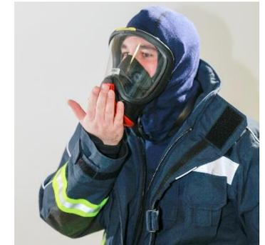
Dicht- und Ausatemventilprüfung der Vollmaske durchführen
