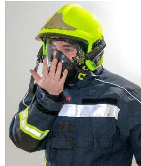
Dicht- und Ausatemventilprüfung der Vollmaske durchführen
