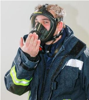
Dicht- und Ausatemventilprüfung der Vollmaske durchführen
