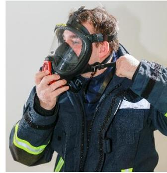
Korrekten Sitz der Vollmaske sicherstellen, und Kopfbänderung „Nackensbänder“ schließen
