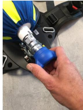
Ventil der Atemluftflasche am Pressluftatmer öffnen Flaschendruckprüfung durchführen, anschließend Ventil schließen
