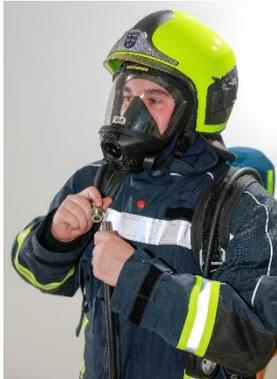
Mitteldruckleitung des Lungenautomaten von Pressluftatmer abkuppeln
