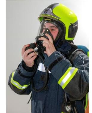
Anschließend Verriegelung des Steckanschlusses an der Vollmaske betätigen und Lungenautomat abschließen
