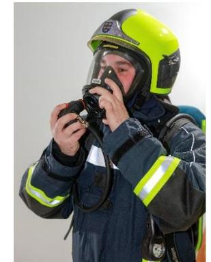
Verriegelung des Steckanschlusses an der Vollmaske betätigen und Lungenautomat abschließen
