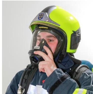
Verriegelung des Steckanschlusses an der Vollmaske betätigen/halten
