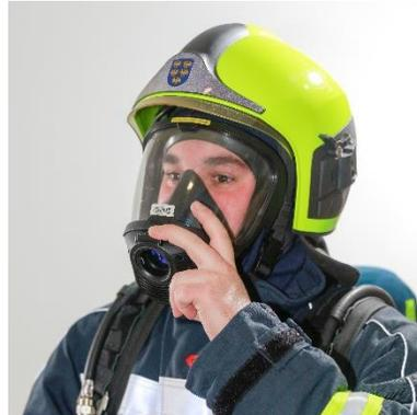
Verriegelung des Steckanschlusses an der Vollmaske betätigen/halten
